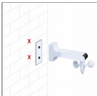
Positionnez et marquez l'emplacement des trous de perçage à l'aide du socle.
