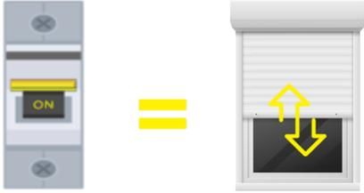
Une fois la **LED bleue** de la télécommande **fixe**, mettez le moteur **sous tension sans relâcher la touche MONTÉE**.
