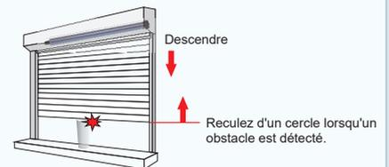
Les lattes se déplacent vers le bas, les vents automatiques reviennent lorsqu'un obstacle est détecté, pour protéger l'objet.
