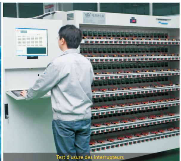
Test d'usure des interrupteurs
