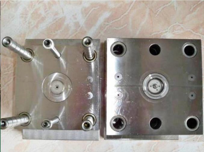
Moules avec engrenage de haute précision
