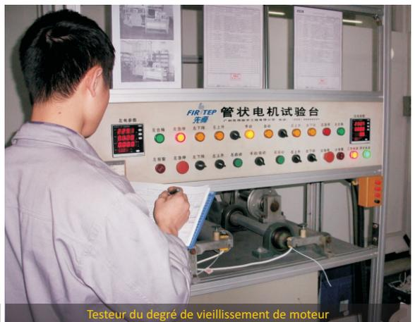
Testeur du degré de vieillissement de moteur
