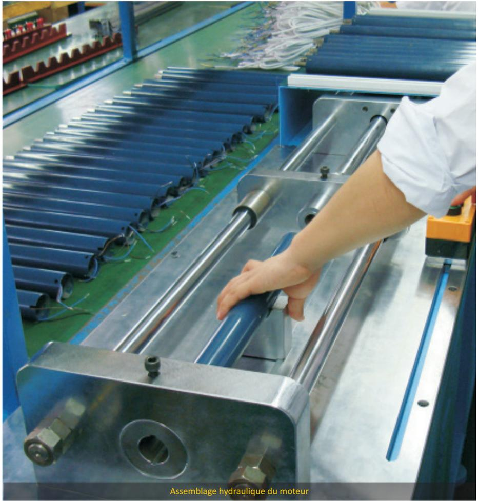
Assemblage hydraulique du moteur
